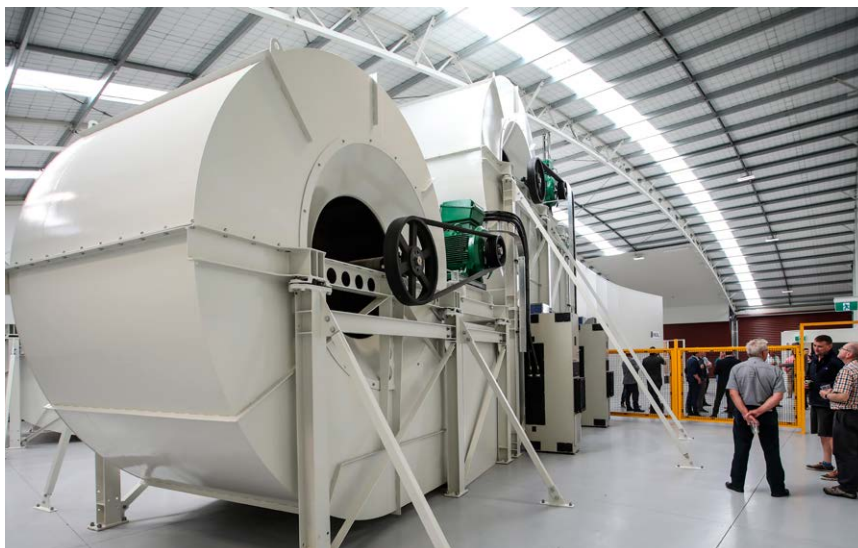
Один из четырех вентиляторов аэродинамической трубы Insol
